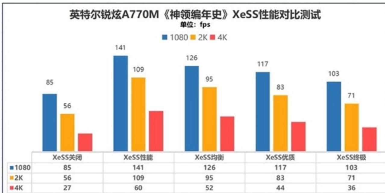
在XeSS各项模式下，性能模式对帧数的提升最大，如在1080P分辨率下，XeSS关闭时帧数为85fps，开启XeSS性能模式之后，帧数达到141fps，提升幅度65.9%，帧数提升显著。
