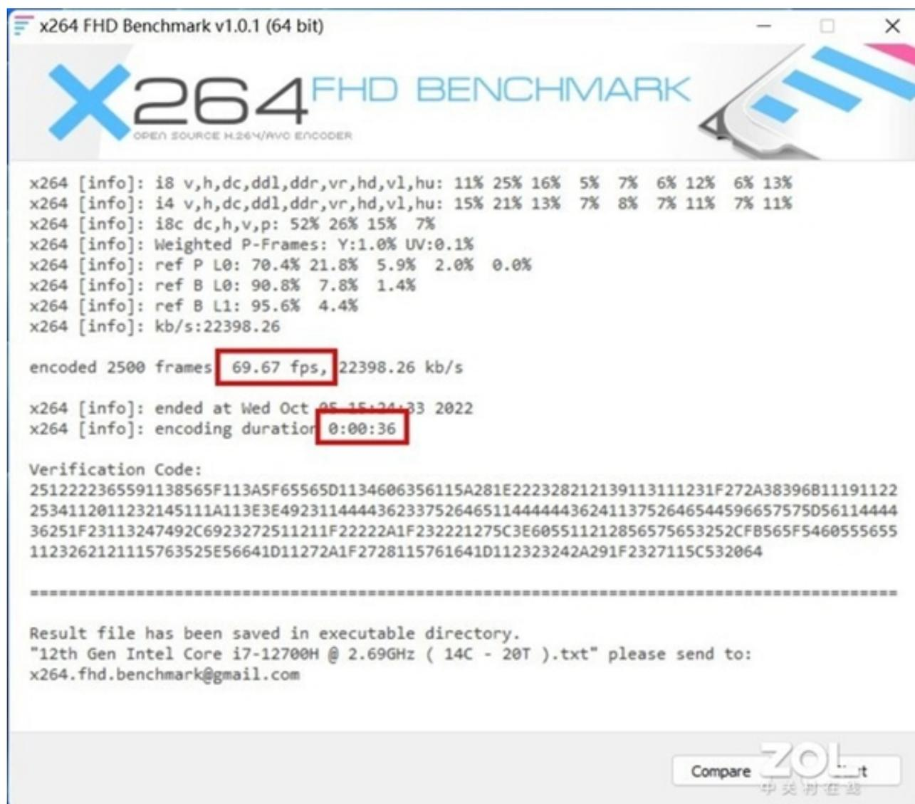
英特尔12代酷睿处理器强化了视频编解码能力，可以在视频处理过程中配合GPU实现更高的处理效率。首先参考X.264Benchmark测试，编码2500 frames用时仅36秒，帧率为69.67fps，视频编码效率极佳，一般笔记本电脑的i7-12700H处理器的编码用时要到40-45秒左右。
