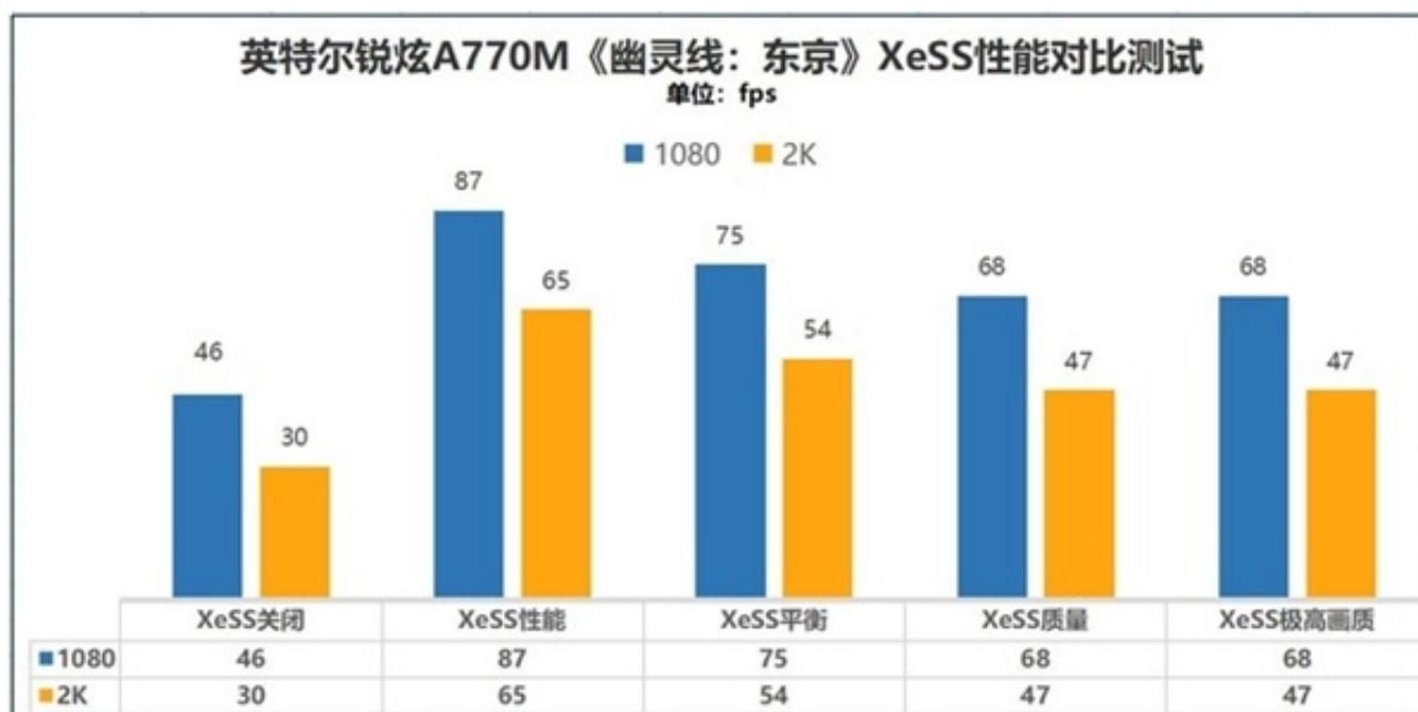
通过测试可以看到，锐炫A770M适合在1080P和2K分辨率下运行这款游戏，2K分辨率下XeSS关闭时为30fps，开启性能模式后可以达到65fps，流畅运行无压力。
