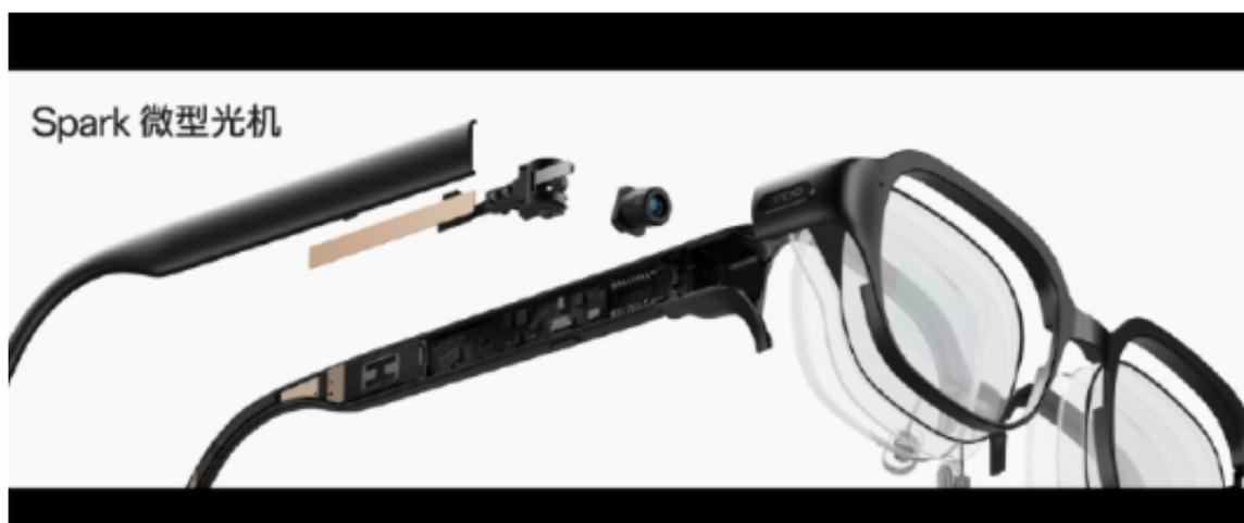
去年，OPPO Air Glass正式发布，搭载了高通骁龙4100可穿戴设备平台，并集成自主研发的Spark微型光机、Micro LED和定制光波导技术，可提供平均1400尼特的入眼亮度。
