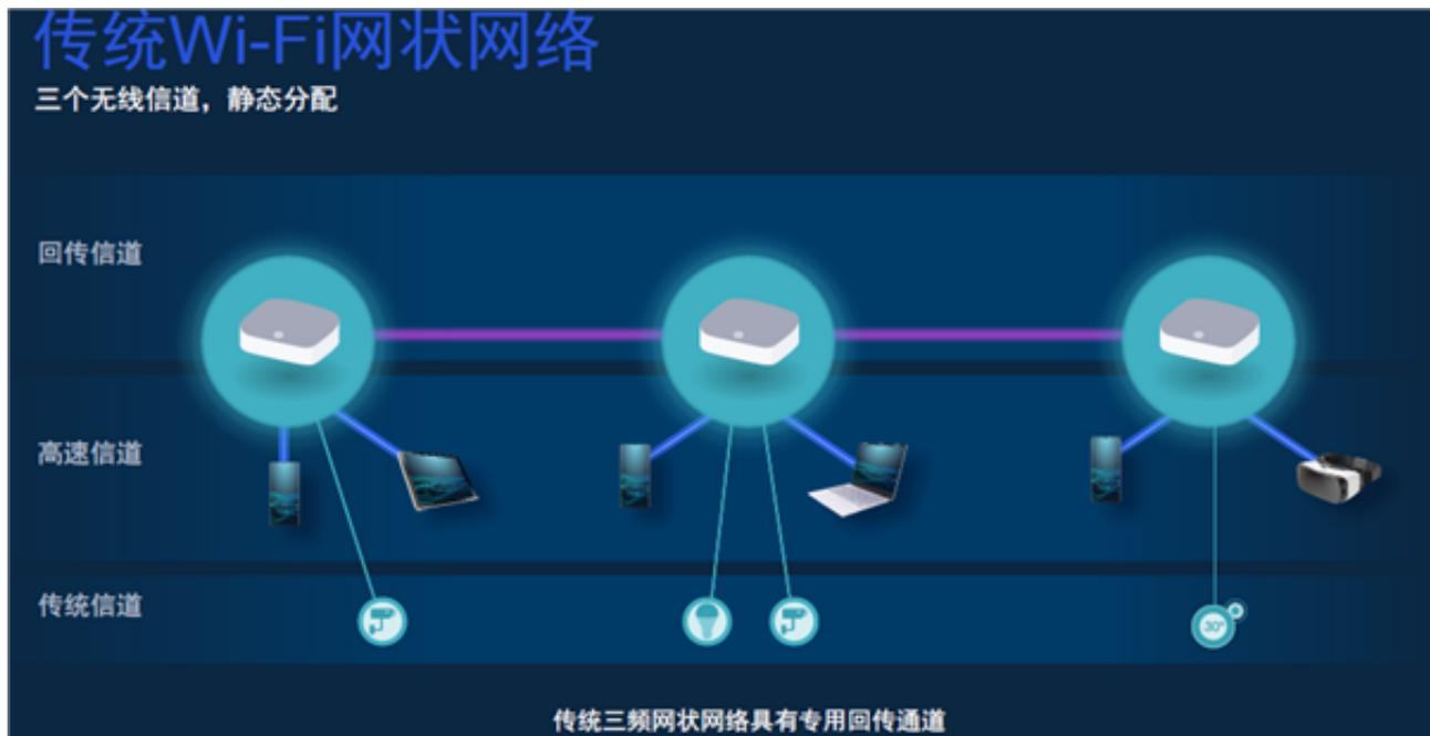
面对干扰，高通多连接网状网络技术也可根据干扰情况，动态聚合或更换附近可用信道。比如回传出现干扰，可以动态切换到另一个高速通道避开干扰；或者高速前传连接中出现干扰，也可以从高速信道B切换到高速信道A，高速连接和稳定性都可以得到保证。
