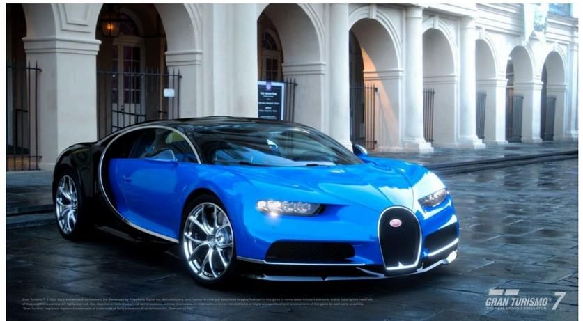
Chiron 是 Bugatti 在 2016 年推出的超级跑车，这款量产车型号称是 Veyron 的后继车，全世界仅出产 500 台。车身外装采用大型 C 形线条环绕座舱，同时也是进气口，搭配受 Type57 Atlantic 双门轿跑车启发的突出中线设计，可提高直线稳定性。碳纤维底盘提供与 LMP1 赛车同等级的刚性，并配备 8 升 W16 四涡轮引擎。该引擎自 Veyron 系列以来，已经大幅调校，最大动力输出可达 1479.3 BHP，峰值扭矩为 163.1kgfm。本车能够在 2.5 秒内从 0 加速到
