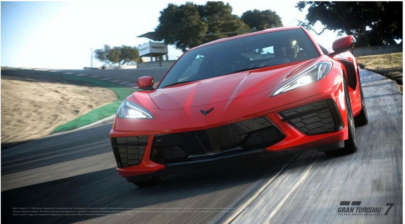
全美跑车代名词 Chevrolet Corvette 在 2019 年发生了历史性的变化——当年发行的第八代 Corvette 成为系列首款采用中置引擎配置的车型。这项革命性变动一眼就能从外观看出来，Chevrolet 的标志性长鼻不复见，随着座舱的前移，车身正好符合经典的中置轮廓。少了引擎，前方现在可充当行李空间，同时引擎后方还有另一个足以容纳高尔夫球袋的行李区。本车的核心 V8 引擎，是以前代车型 C7 的 LT1 引擎为基础开发的新一代小型 LT2。具有 6.2 升排量，可产生 495.1BHP / 65.0 kgfm，还具备像停缸技术这样的省油功能。变速箱采用 8 速双离合自排，但也可使用方向盘上安装的换档器进行手排操控。悬吊系统则在 4 个角落都采用双叉臂式结构，并搭载高度调整系统来应付
