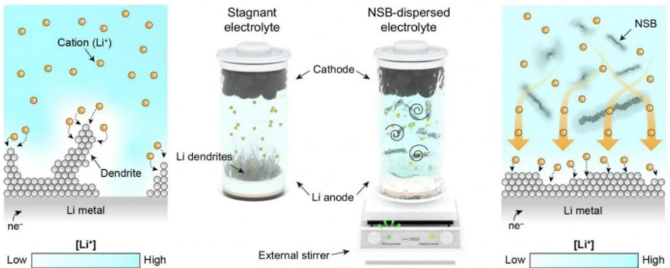
插图描述了概念性电池系统中的磁力搅拌电解质
