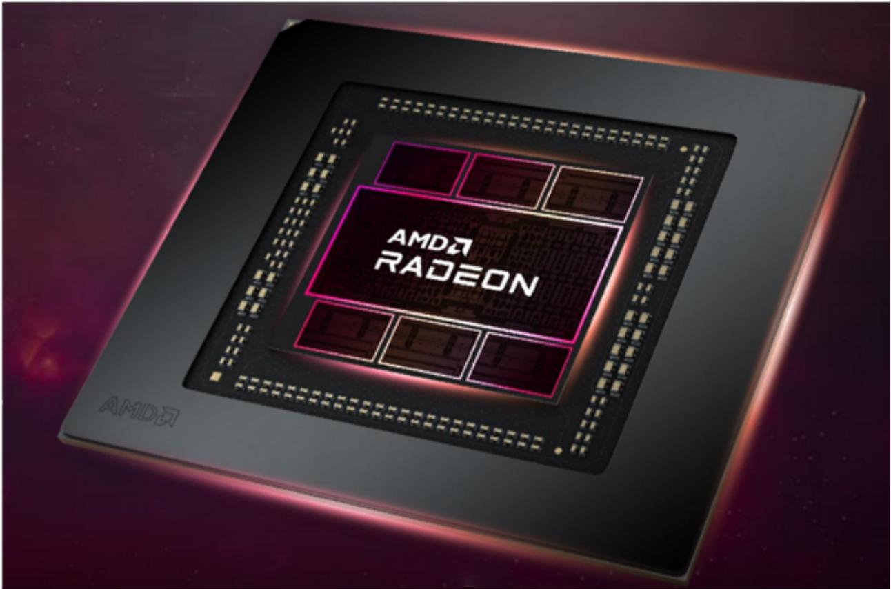
据Wccftech报道，Radeon RX 7900系列里搭载的Navi 31为A0步进，而不是一般情况下的A1或者B0步进，这意味着很可能在第一次流片以后直接就出货了，没有进行调整。在新工艺、新架构和新封装的情况下，取得这样的效果已是相当不错了。
