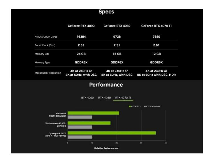
如上图所示, RTX 4070 Ti 拥有 7680 CUDA 核心, 加速频率可达
