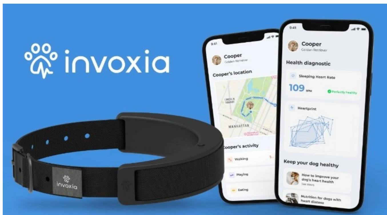
兽医专家帮助开发了该智能项圈。该设备通过微型雷达传感器、加速计和项圈内的边缘人工智能捕捉和处理健康数据，以测量运动、呼吸和心率。
