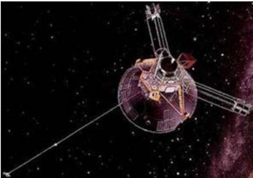
先驱者11号探测器在1973年4月6日，位于佛罗里达州的卡纳维拉尔角发射。探测器全长2.9米，设有一个直径2.74米的高增益天线，在其之前再装上一个中增益天线。至于另外一条全方位低增益天线则装设于高增益天线接收器之下。探测器以两个放射性同位素热电机（RTG）作为能源，在拜访木星时仍能产生144 瓦特，但到达土星时只能产生100瓦特的功率。
