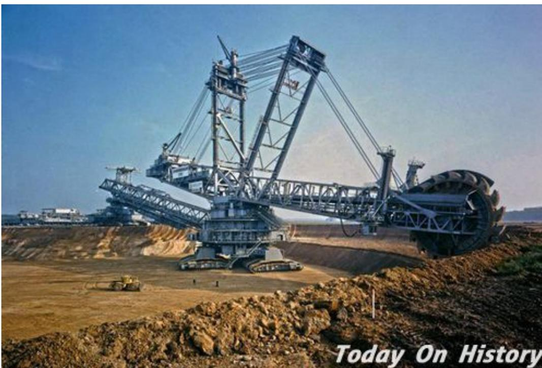
它的设计制造时间长达五年，需要有五人进行操作，铲斗机轮的直径为70多英尺，共有20个铲斗，每个铲斗可以承受530多立方英尺（泥土等），一个6英尺高的人可以站在铲斗内，挖土机依靠12个用于行进的轮状物前进（每个轮状物宽12英尺 高8 长46）八个在前，四个在后，挖土机的最快速度为三小时一英里。从远处看它，非常的壮观，如果近距离接触它，应该会有了一种到了外星的感觉。
