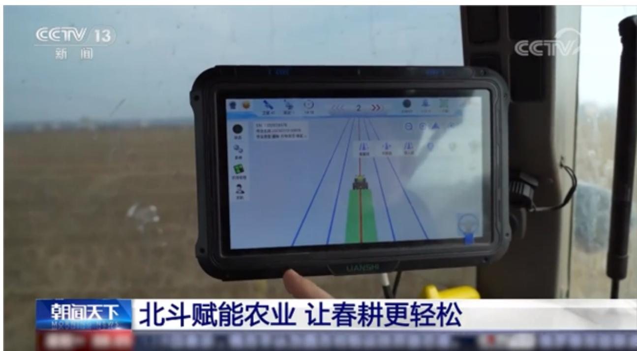
北斗自动驾驶终端在当地已经安装了1600多套，它能规划多条行驶路径，并实时显示拖拉机当前所处的路线。
