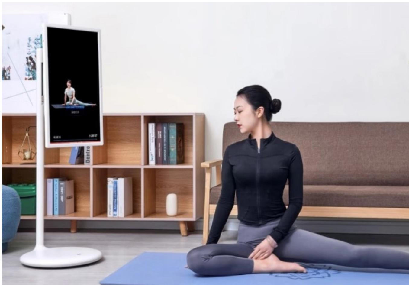
据官方介绍，该产品内置电池且配有静音万向轮，辅以隐匿式滑轮、可多角度调节和升降的移动支架，可实现自由移动与屏幕多高度 / 角度调节的操作。此外，小度还为添添闺蜜机配备了全域 AI 语音控制功能，让用户体验解放双手的使用体验。屏幕方面，这一产品选用了 27 英寸的 AG 类纸屏，抗反光、防眩光、不伤眼。
