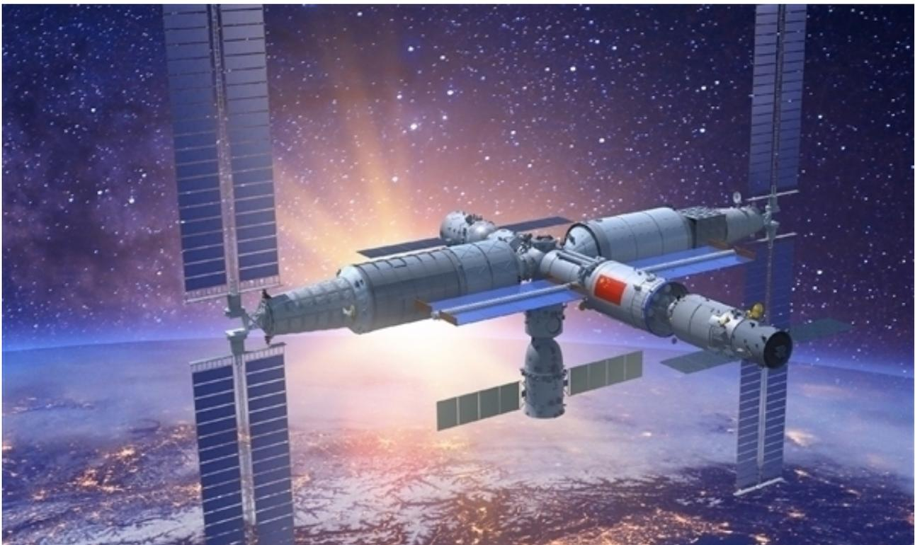
同时，问天、梦天两个实验舱的气闸舱分别位于“T”字一横的端头，正常工作泄压或异常隔离时均不影响其他密封舱段构成连贯空间，保证了安全性。
