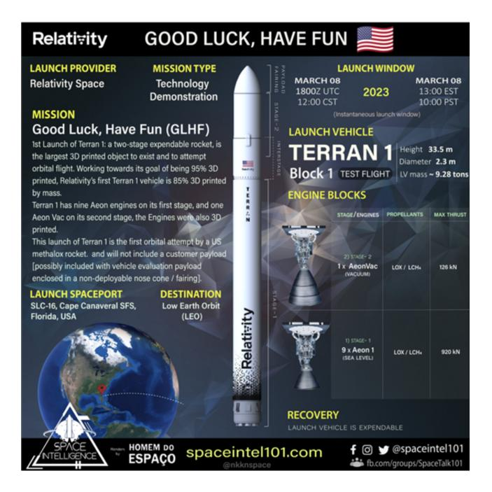
据了解,这枚3D打印火箭高33.5米,直径2.3米,LEO运力1.25吨。一级火箭动力由9台Aeon
